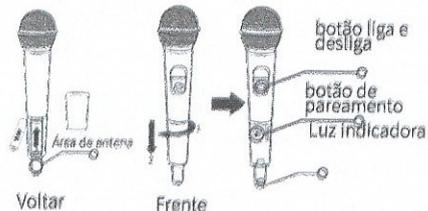
Como ilustrado, desencaixe a parte de baixo do microfone. Coloque duas pilhas AA no microfone.
